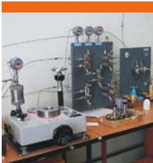
Преобразователи давления, производимые по стандарту ISO 9001, калибруются на сверхточном оборудовании. Калибровочная лаборатория оснащена современными прецизионными эталонами давления. Минимальная интегральная погрешность установок составляет  $\pm 0,005\%$ .
