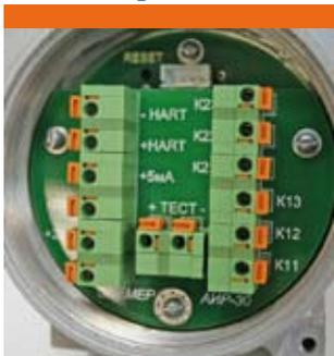
Под задней крышкой находятся удобные безвинтовые клеммные колодки для коммутации электрических цепей и тестовые клеммы для проверки токового сигнала.
