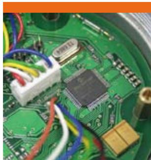
Помимо один или два унифицированных токовых выходов 0...5 и 4... 20 мА, датчики ЭЛЕМЕР АИР-30 поддерживают работу с современными АСУ ТП по HART-протоколу.
