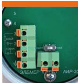
В датчиках с HART-протоколом предусмотрена возможность тестирования токовой петли и HART-сигнала.
