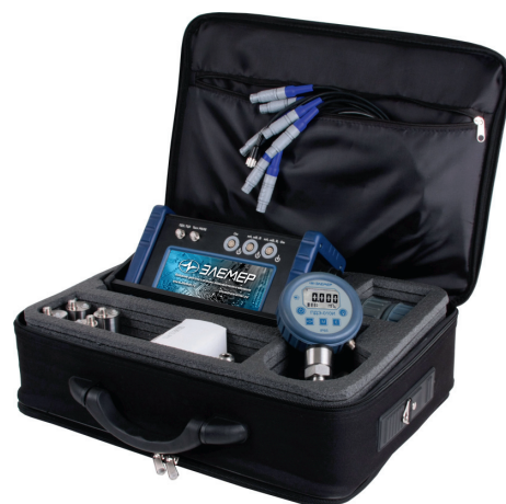
ПДЭ-010И в составе поверочного комплекса ЭЛЕМЕР-ИКСУ-2012ПК
