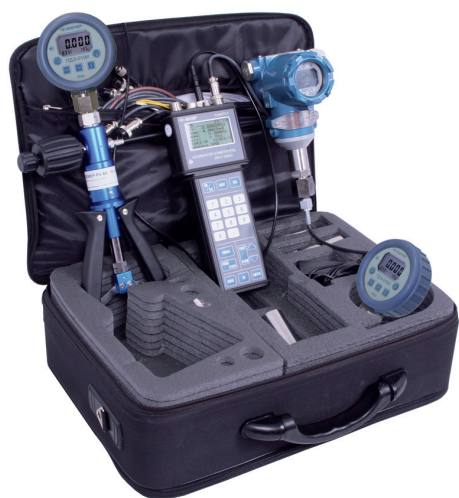
ПДЭ-010И в составе поверочного комплекса ЭЛЕМЕР-ПКДС-210
