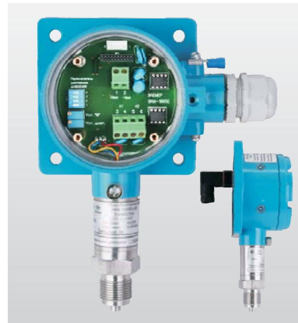
Под крышкой манометра и модулем индикатора находятся потенциометры подстройки нуля и диапазона, микропереключатели диапазонов измерения, клеммные колодки для подключения к ПК и установочные гнезда для двух оптореле, которые позволяют оперативно произвести замену или переконфигурирование исполнительных устройств.
