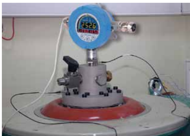
ЭКМ-2005 на испытательном вибростенде — 2000 Гц/ 10 г/ 0,75 мм
