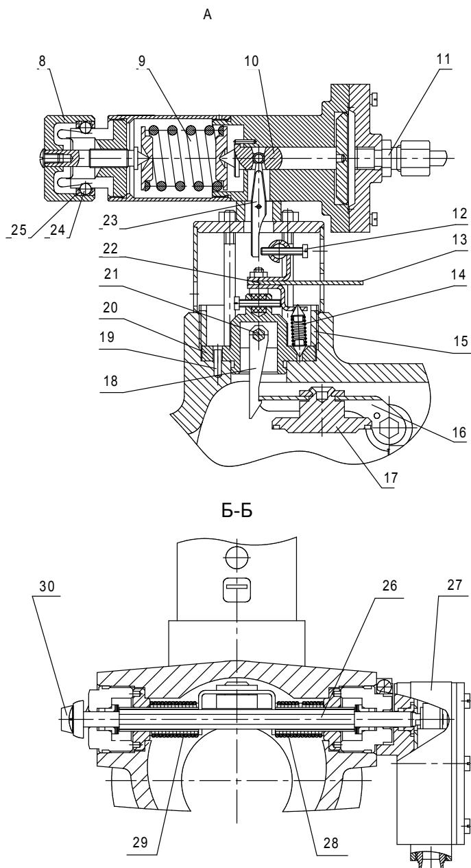
Рис.2 (продолжение) – Устройство защитное ЗУ 80М-04 000
