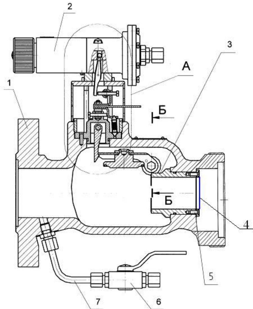
Рисунок 2 - Устройство защитное ЗУ 80М-04 000
