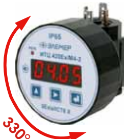
ИТЦ 420/М4-2 со встроенным оптореле
