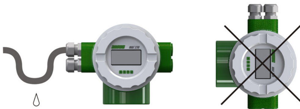
Рисунок 2.8 - Рекомендации по расположению кабелей и кабельных вводов
