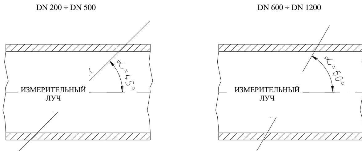
Рис.1 – Ультразвуковой угол ориентации луча относительно оси трубопровода
