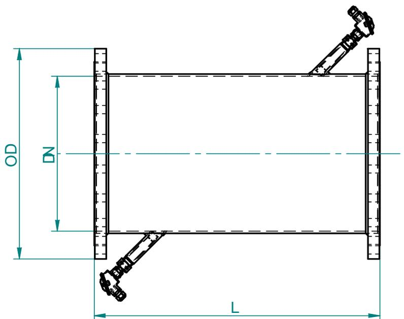
Рис.2 – Размерная схема датчика расходомера
