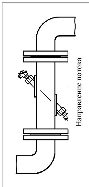
Рис. 11 – Датчик, установленный в вертикальном сечении трубы
