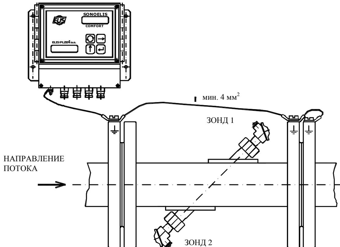
Рис. 14 – Заземление электронного блока и датчика расходомера
