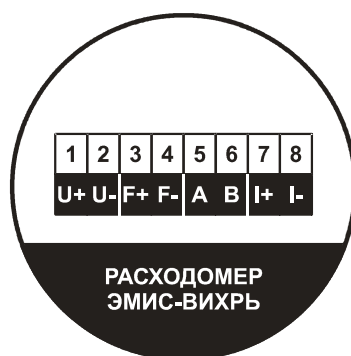
Рисунок Б.1 - Расположение зажимов клеммной колодки
