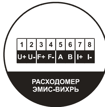
Рисунок Б.1 - Расположение зажимов клеммной колодки
