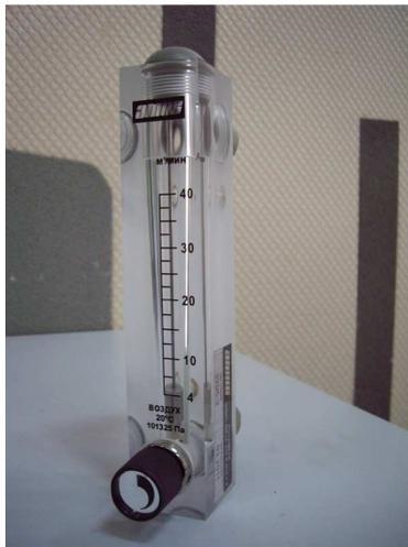
Рисунок 1.3 - Общий вид панельного ротаметра ЭМИС-МЕТА 210-Р, Ду 10
