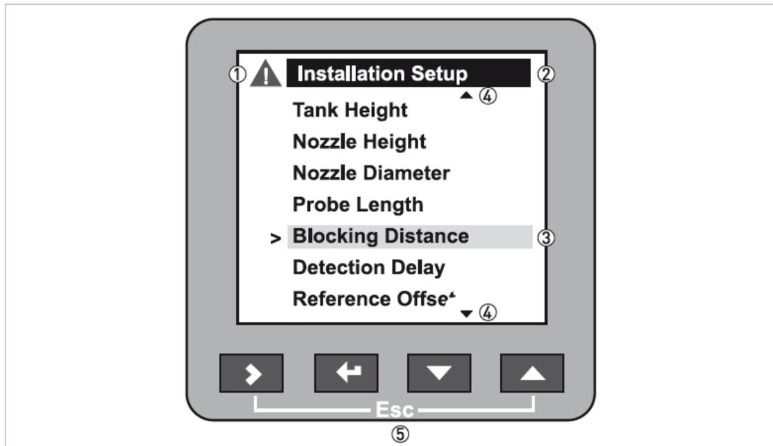
Рис. 5-1: Расположение информации на экране дисплея в режиме программирования
