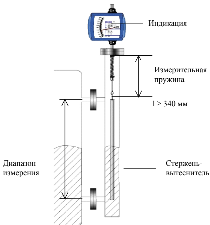
Рисунок 1: Применение BW 25 с выносной камерой
