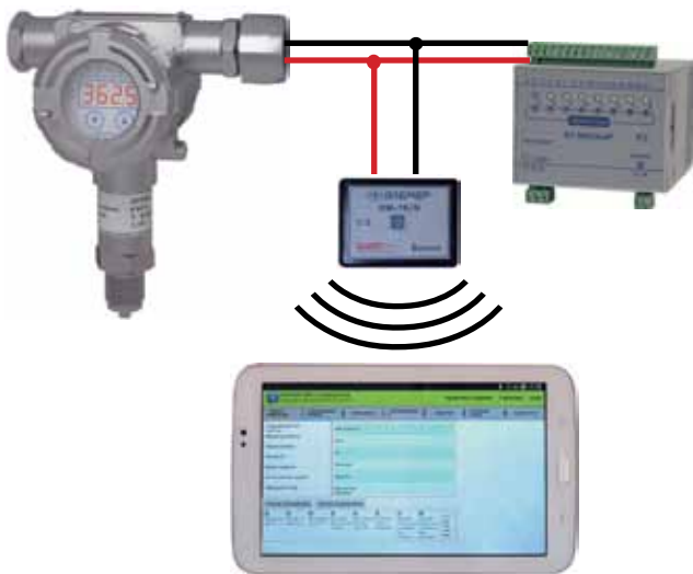
АИР-10SH в режиме работы с планшетным ПК с ОС Android и с модемом HM-10B по bluetooth каналу
