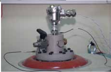
AIP-10SH на испытательном вибростенде (2000 Гц/ 10 г/ 0,75 мм)
