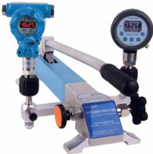
Поверка AIP-10SH на перегрузочную способность с эталонным манометром ПДЭ-010И. Р перегрузки = 500% ВПИ
