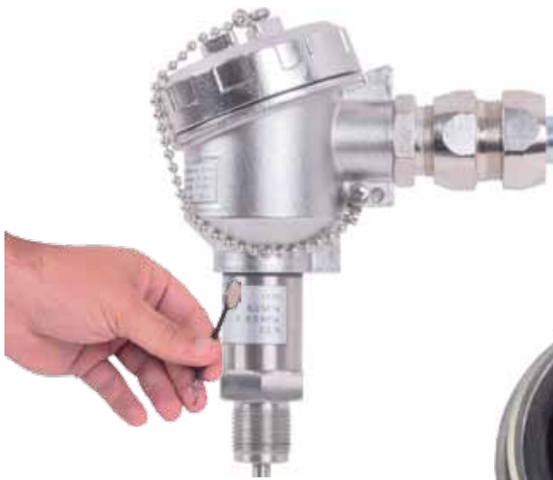
AIP-10SH в режиме установки «нуля» с помощью магнитного брелока
