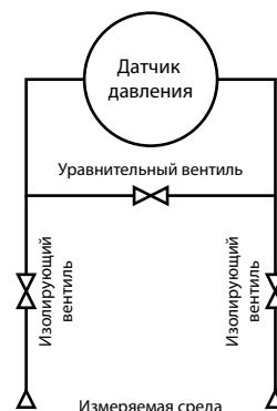
Схема подключения
