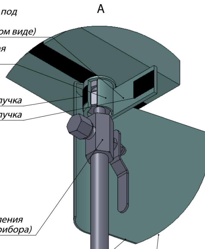
Защитная юбка вентиляционного блока (показана в расстегнутом виде)
