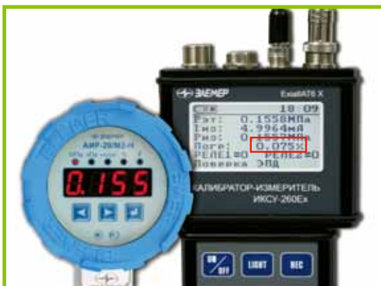
Основная погрешность 0,075% при измерении ИКСУ-260Ех
