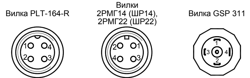
Рисунок 2.5 – Расположение контактов вилок
