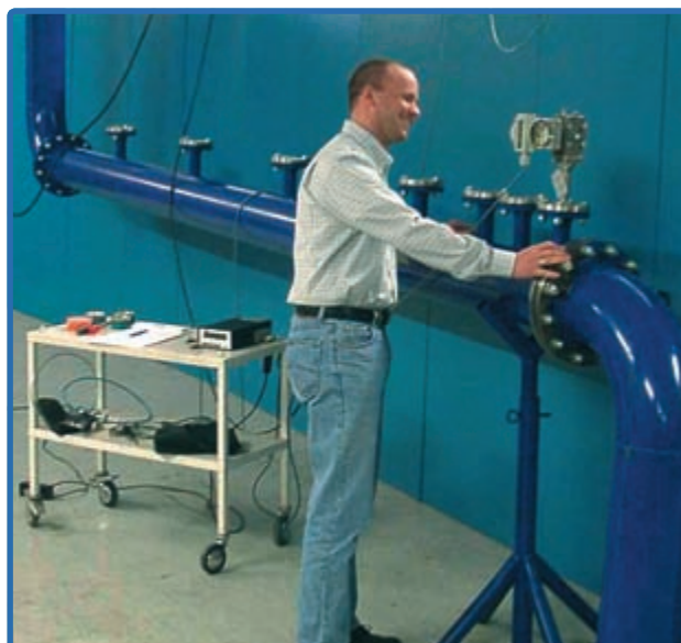
Испытательный комплекс systec измеряет производительность укороченного входного тракта на deltaflow.
