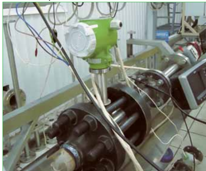
Вихревой расходомер высокого давления ЭМИС-ВИХРЬ 200 ППД на поверочном стенде
